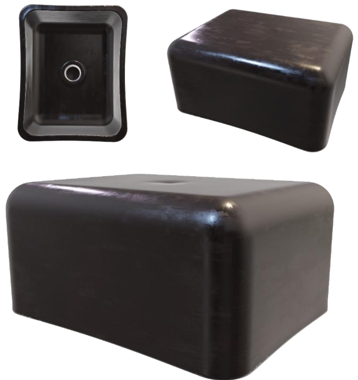
Rendu réaliste 3D, comprenant les défauts de la pièce - SIMCON
