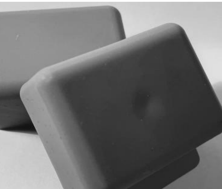
Pièce réalisée en impression 3D en résine, comprenant les défauts de la pièce - SIMCON
